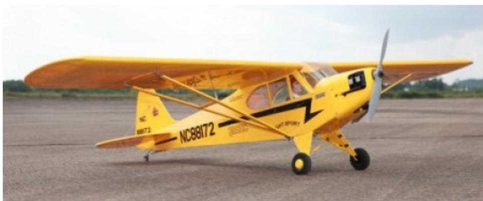
Un train classique a ses deux roues principales positionnées à l'avant du centre de gravité de l'avion, ce qui implique que la queue touche le sol. L'avion possède donc une petite roulette de queue sous l'empennage arrière.
